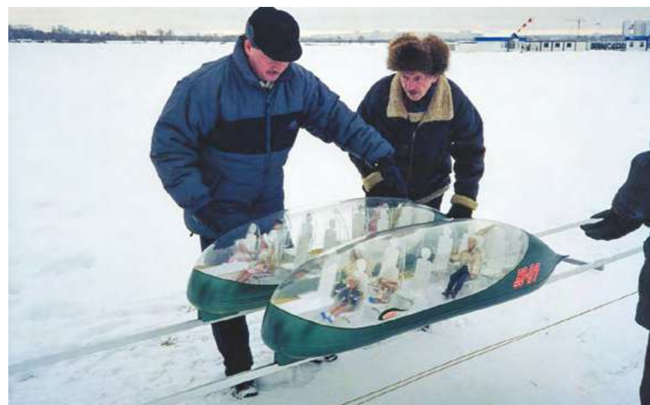
Первое испытание бирельсовой трассы и модели двухкорпусного юнибуса масштаба 1 : 5, аэродром Тушино, декабрь 2000 г.
