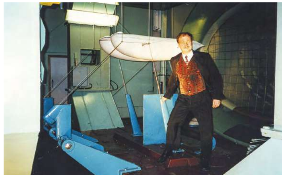
Продувка модели двухкорпусного юнибуса масштаба 1 : 5 в аэродинамической трубе, г. Санкт-Петербург, октябрь 2000 г.
