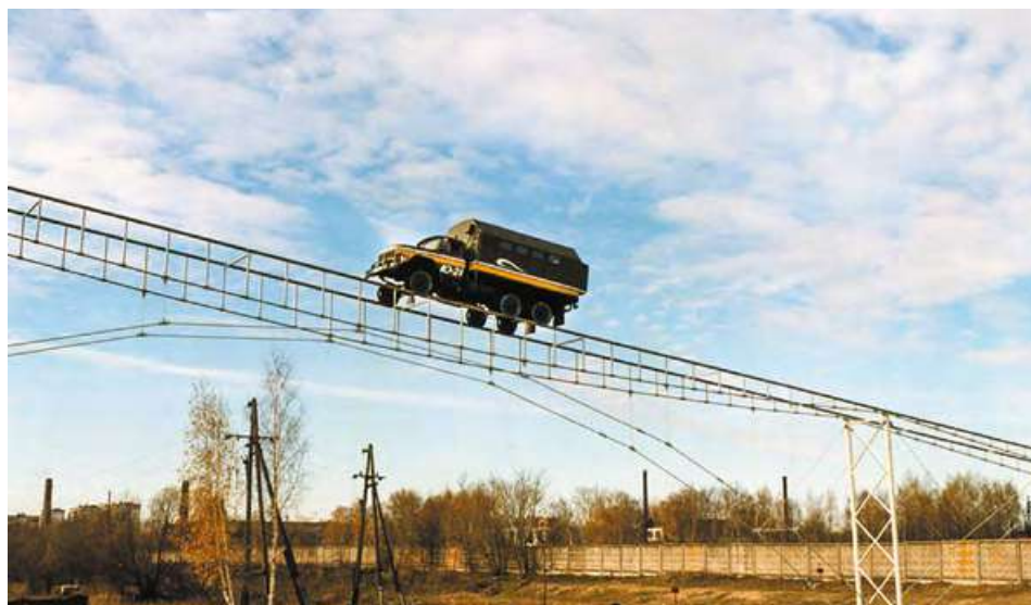
Пробные испытания путевой структуры СТЮ, г. Озёры Московской области, октябрь 2001 г.
