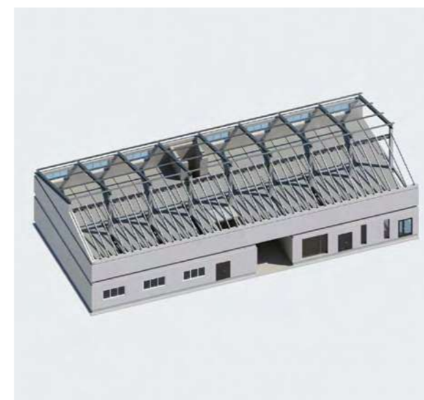
Рисунок 11 – Конструктивная схема многофункционального здания из сборных элементов (фрагмент, вариант)
