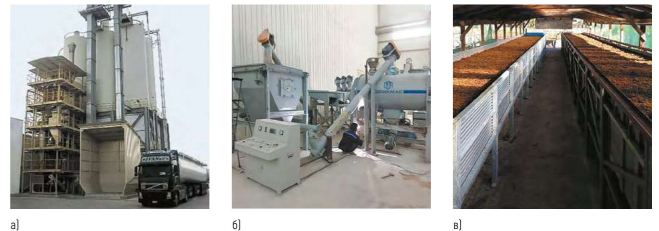
Рисунок 7 – Оборудование для производства лёгких почвогрунтов: а – печь для производства перлита; б – смеситель с питающим бункером для получения лёгкого почвогрунта; в – комплекс для производства биогумуса
