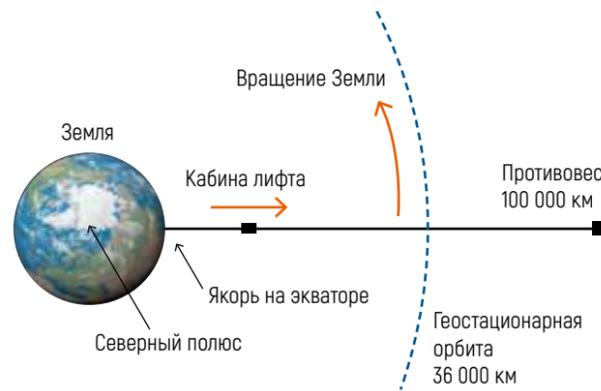
Рисунок 1 – Схема космического лифта
