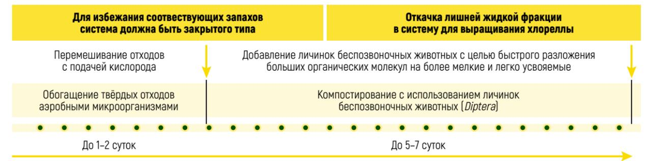
Рисунок 4 – Элемент биологического реактора для переработки твёрдой фракции отходов
