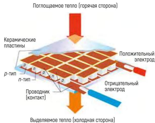
Рисунок 3 – Устройство термоэлектрического преобразователя
