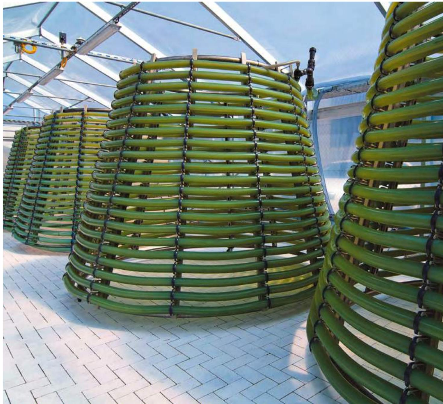
Рисунок 6 – Фотобиореактор для культивирования хлореллы закрытого типа
