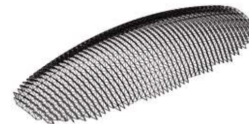
Рисунок 5 – Вариант конструктивного решения ЭКД-Земля из фрагмента тора (высота – 30 м)
