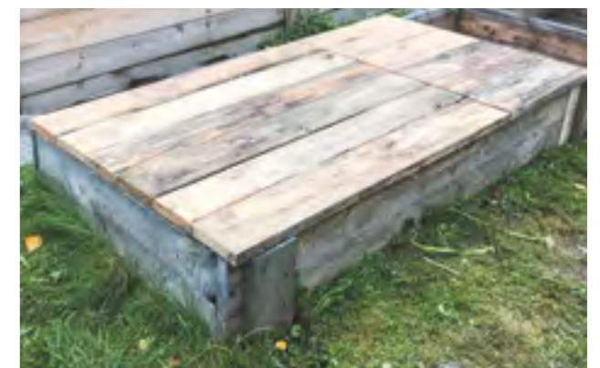
Рисунок 2 – Конструкция деревянного короба для изучения процесса биоразложения ТБО
