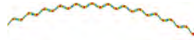
Рисунок 8 – Визуальное отображение частоты собственных колебаний маховика. Деформации (амплитуда неровностей) увеличены в 10 000 раз
