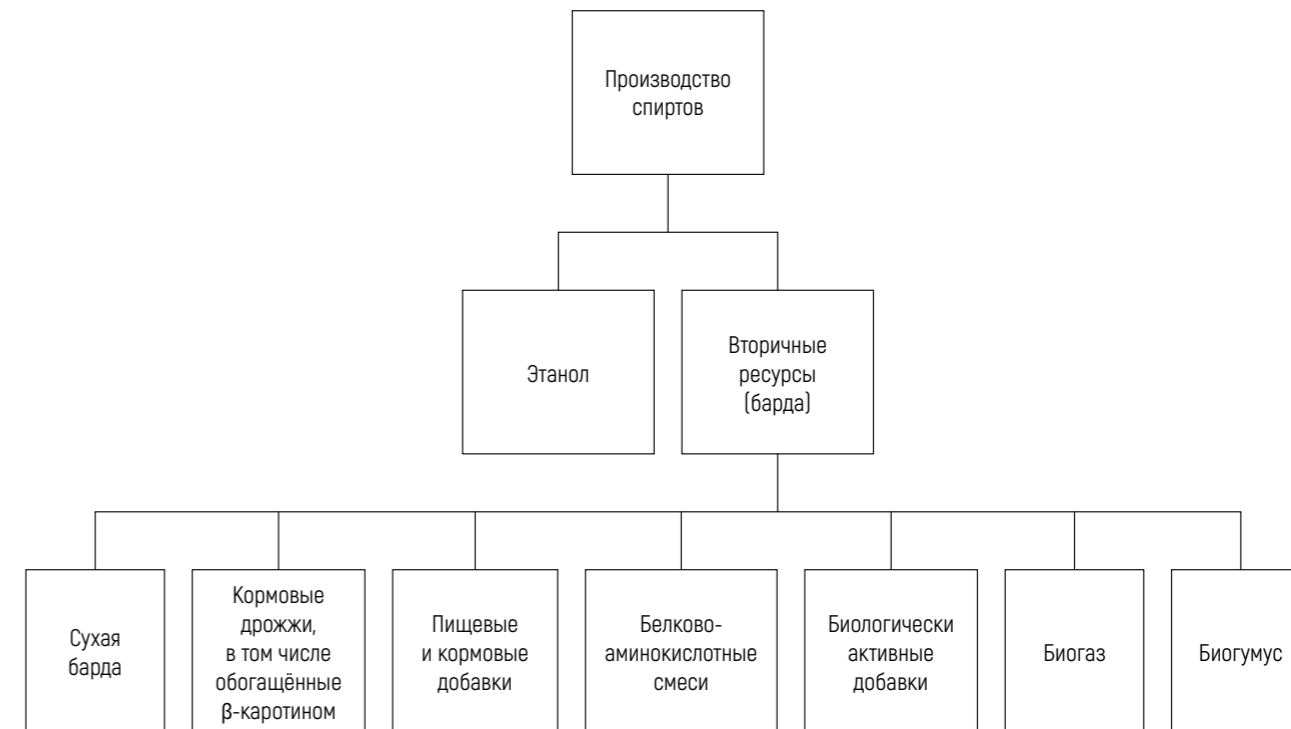
Рисунок 1 – Схема комплексной переработки сырья для ресурсосберегающей технологии производства спиртов
