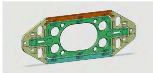
Рисунок 17 – Визуализация 3D-модели секции магнитного подвеса ОТС
