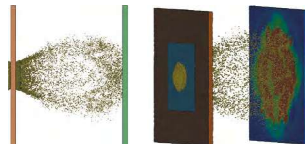
Рисунок 2 – Моделирование удара сферы диаметром 2 мм о стенку бака
